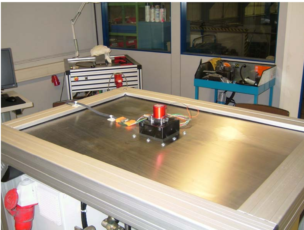
Abbildung 5. Diese Abbildung zeigt ein auf den Testsand aufgebautes Servoventil. Es handelt sich um ein Ventil des Airbus A340. Da das Pumpengeräusch sehr gering ist, wird dem Operator durch eine Lampe das Anstehen des Drucks angezeigt.
