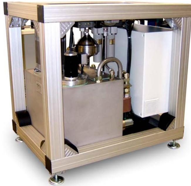
Abbildung 6. Diese Ansicht zeigt das Hydraulikaggregat mit dem 100 Liter Öltank, der Heizung und der Wasserkühlung, die eine Temperaturregelung in einer Genauigkeit von \pm 2^\circ\text{C} gewährleistet. Das Hydrauliköl wird mit einer Pumpe durch das Kühlaggregat gefördert, und zwar mit variabler Geschwindigkeit in Abhängigkeit der notwendigen Kühlung.
