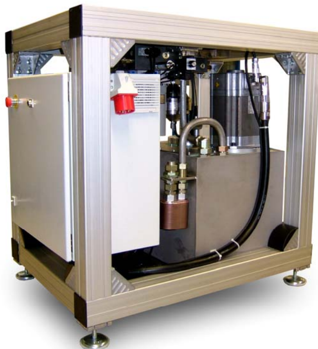
Abbildung 7. Auf dieser Abbildung ist der Synchron-Servomotor von einer Leistung von 10 kW zu erkennen. Bei erreichtem Druck und kleinem Durchfluss ist das Pumpengeräusch kaum vernehmbar.
