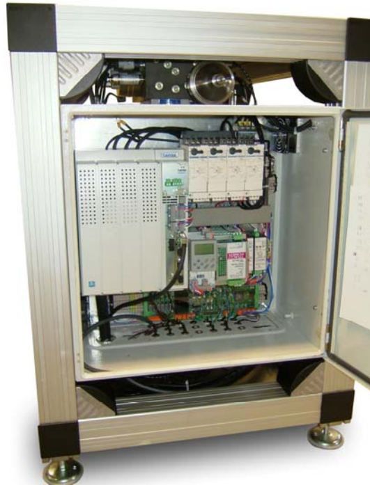
Abbildung 8. Die gesamte Elektronik ist in einem Gehäuse untergebracht. Das Elektronik-Gehäuse enthält die Schnittstellen und Regler-Elektronikkarte, die Antriebs-Elektronik der beiden Servomotoren, das Netzfilter, die verschiedenen Netzteile, die Motorschütze und Sicherungen.
