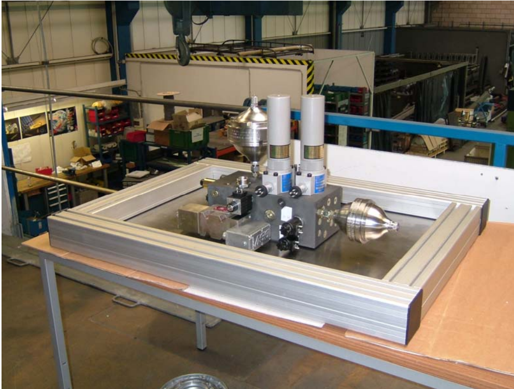
Abbildung 4. Dieses Bild zeigt eine Aufnahme während des Aufbaus des Teststands. Man erkennt das Konzept, dass die Messinstrumente, Ventile, Druckgeber, Accus und Filter auf einem Stahl-Manifold aufgebaut sind.
